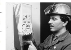
7 Distributeur de protecteurs d'ouïe: les protecteurs d'ouïe doivent être facilement disponibles à tout moment.
